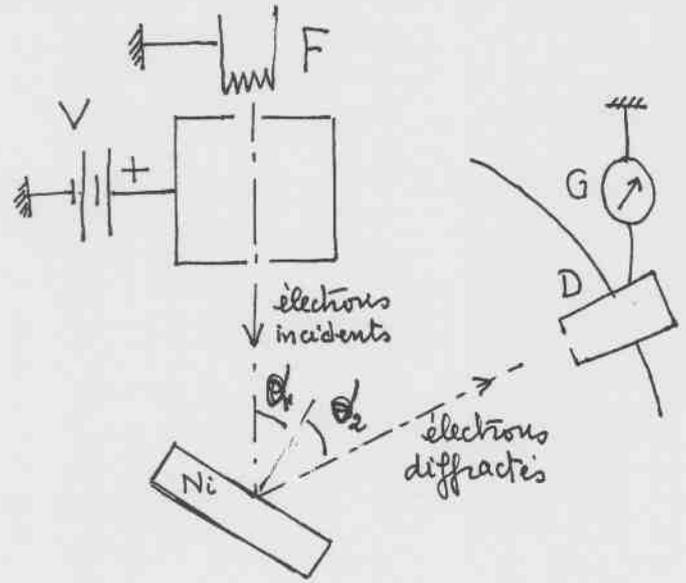
F filament qui produit des électrons accélérés par V et dirigés sur une cible de Nickel. On observe les électrons réfléchis par le Nickel à l'aide du détecteur D et on mesure un courant à l'aide du galvanomètre G
