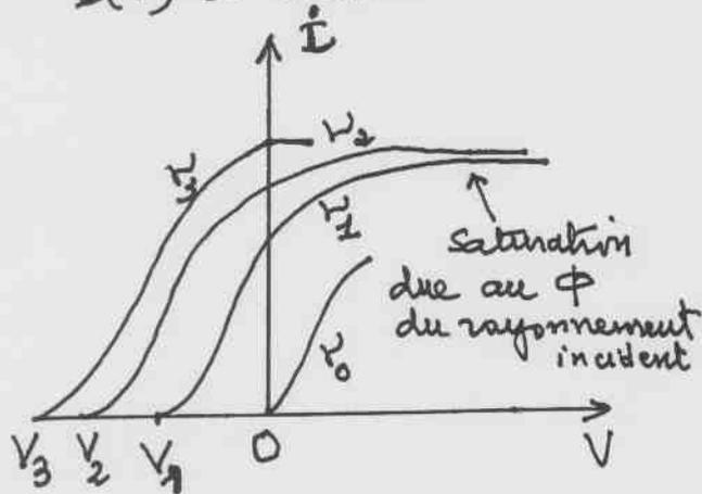
Si on utilise avec le même montage donc la même électrode, des rayonnements de fréquences différentes, on obtient les courbes ci-contre
