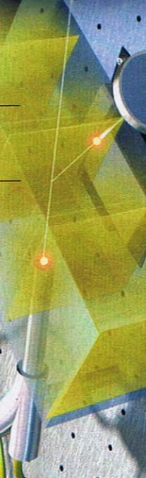
**4** Chaque photon pénètre dans un verre spécial excité par un élément piézo-électrique. Les vibrations de celui-ci engendrent des ondes acoustiques qui, se déplaçant à très grande vitesse dans le cristal, se comportent comme des miroirs semi-transparents : le photon peut soit être réfléchi, soit passer à travers.
